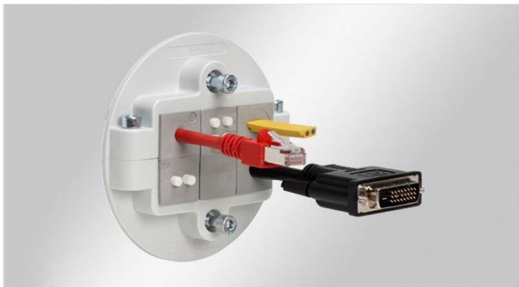
Il KVT 80 è un pressacavo divisibile per il passaggio e la tenuta di cavi con connettori o cablaggi completi. Ma anche di linee elettriche, pneumatiche o idrauliche senza terminali o connettori; anche i tubi corrugati possono passare facilmente (ad esempio in pannelli di controllo, custodie o macchinari).
